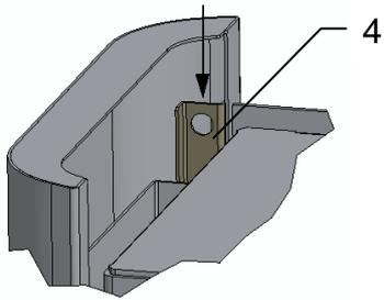
Durch nach unten drücken der Verriegelungsleiste (4) wird das Seitenteil fixiert.
