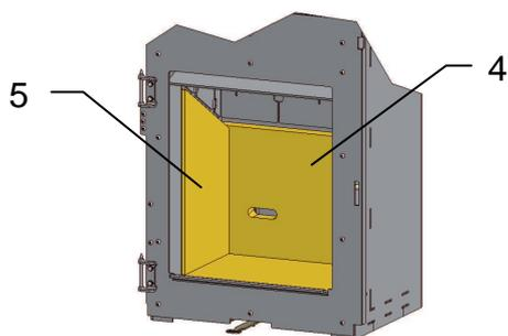
Linken Seitenstein (5) mit Schräge zum Rückwandstein (4) einsetzen und an die Feuerraumseitenwand schieben.
