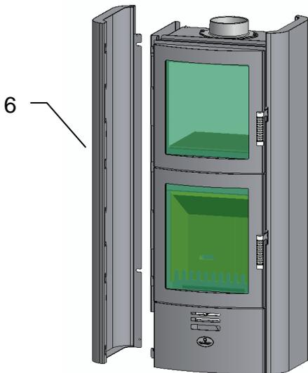
Die Montage der linken Verkleidung (6) erfolgt analog.
