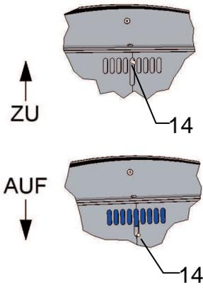
Im Backfach oben befindet sich der Dampfabzugsschieber (14).
