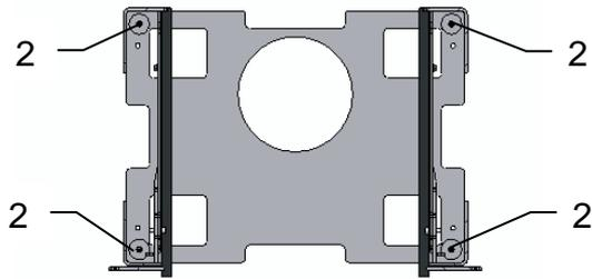
Zum Justieren der Stellfüße (2) die Schublade (1) ausbauen. Durch Drücken der Verriegelungshebel an den Teleskopschienen werden diese getrennt und die Schublade kann entnommen werden.
