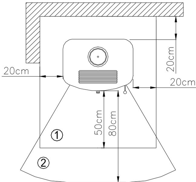
Im **Sichtbereich** des Feuers (Strahlungsbereich) muss ein Abstand von 80 cm zu brennbaren Bauteilen eingehalten werden.
