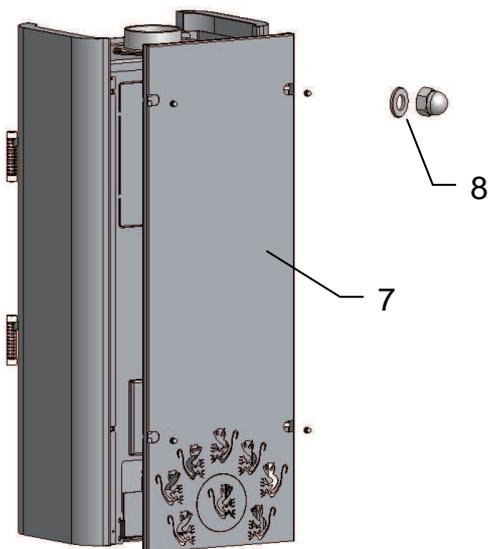
Die Seitenverkleidungen und die Rückwand werden miteinander verschraubt.
