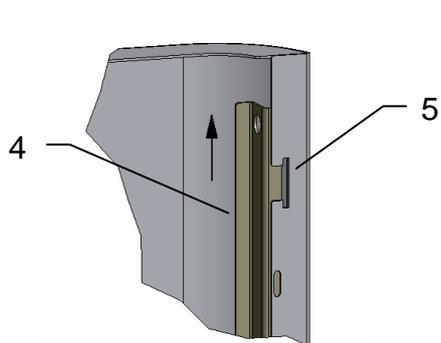
Vor der Montage der rechten Verkleidung (3) muss die Verriegelungsleiste (4) nach oben gezogen werden, bis die Schlitz (5) an der Vorderkante der Seitenverkleidung offen sind.
