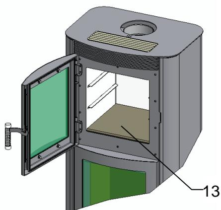
Beim Einlegen des Backfachbodens (13) darauf achten, dass die Flachdichtungen (12) nicht verschoben werden.
