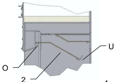
Umlenkplatte (2) wie abgebildet auf oberer Auflageplatte (O) und hinteren Auflegewinkel(U) ablegen.
