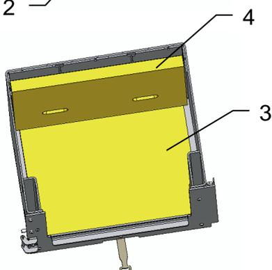
Bodenplatte (3) mit Sichtseite nach oben entsprechend der Ofenkontur einlegen und nach vorne schieben.
