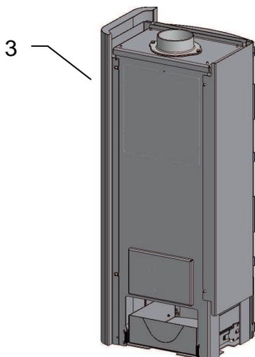
Das Seitenteil (3) auf die Haken an der Frontplatte schieben, bis diese ganz an der Frontplatte anliegt.
